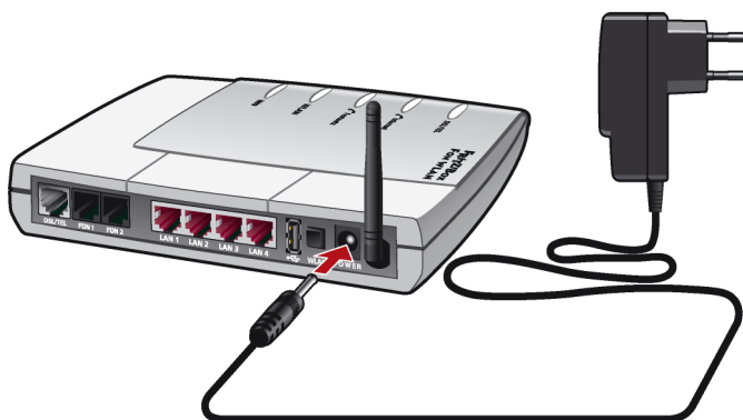
Conexión a la alimentación eléctrica
